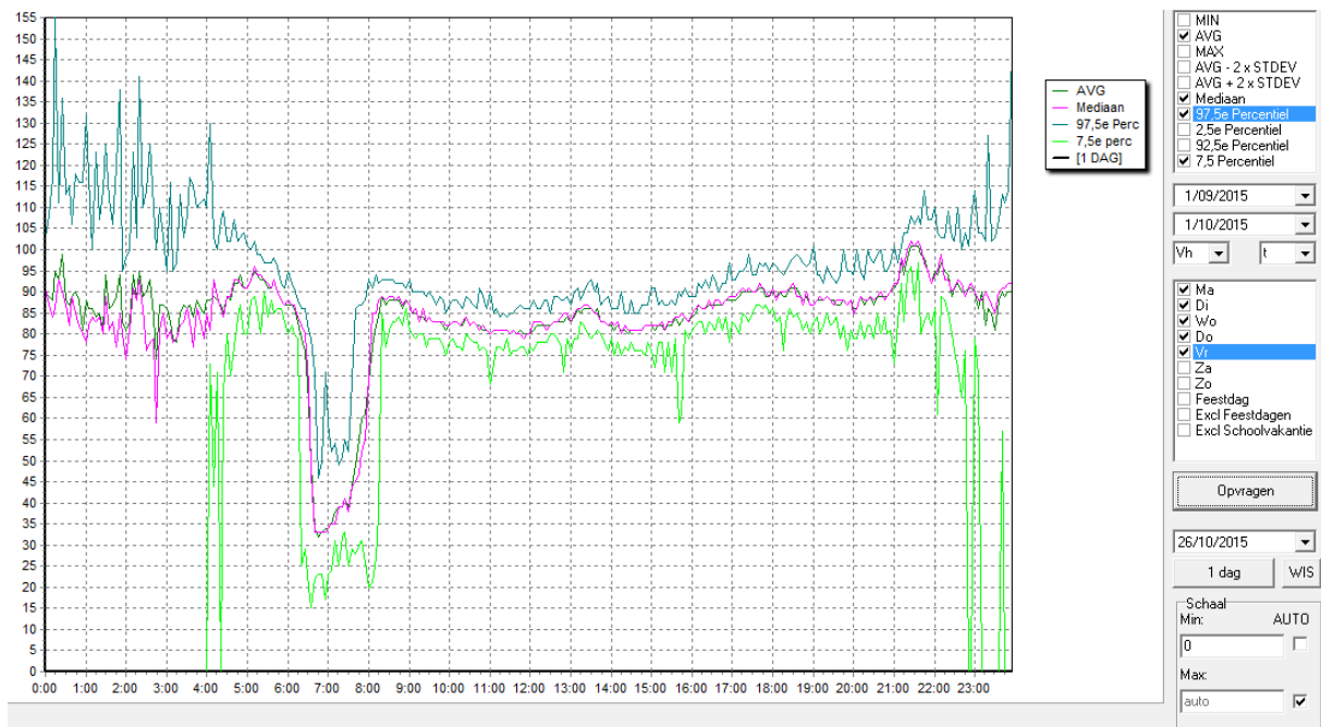
Snelheid in Tijlmanstunnel (werkdagen september 2015)
