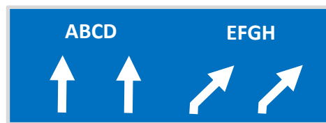
verticale signalisatie i.g.v. dubbele uitvoegstrook
