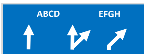
verticale signalisatie i.g.v. uitvoegende taper
